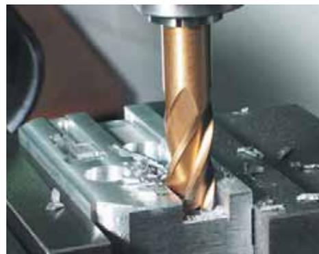
Spanabnahmen von 3 oder 4 Millimetern sind für die Maschine nicht zu viel, auch nicht in Stahl
