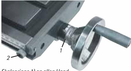
Skalenringe 1) an allen Handrädern ermöglichen die Dosierung der Vorschubbewegung bis auf 5 Hundertstel Millimeter genau. Mit Hilfe zweier Endanschläge vorn am Arbeitstisch 2) lässt sich der Verfahrweg in Längsrichtung begrenzen. Wiederholgenaueres Arbeiten ist so leicht möglich
