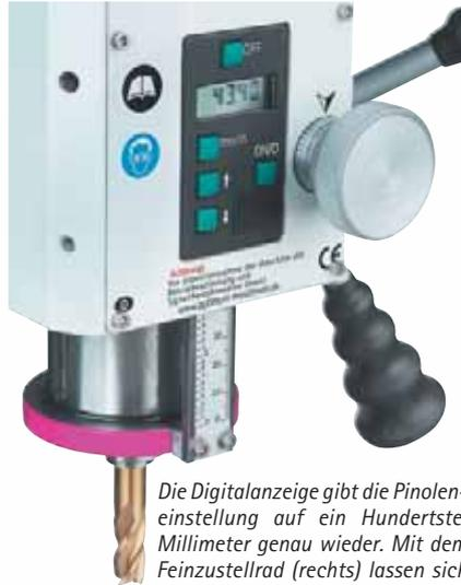
Die Digitalanzeige gibt die Pinolen-einstellung auf ein Hundertstel Millimeter genau wieder. Mit dem Feinzustellrad (rechts) lassen sich somit kleinste Abtragsdicken präzise einstellen. Durch „Nullen“ der Anzeige und Hoch- oder Runterzählen lässt sich ein Vorgabewert einstellen, von dem aus bequem auf Null zurückgefahren werden kann
